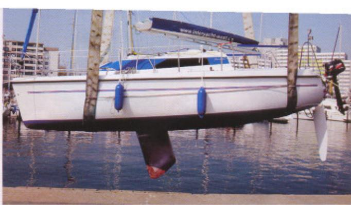
**FAN** Füllige Linien, Ballastschwert, tiefes Ruder. Mit dem Schiff kann man völlig problemlos trockenfallen, was auch für die Deltania und die Sun gilt. Die übrigen benötigen Wattstützen
