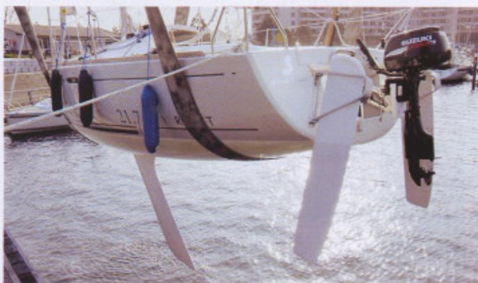
**FIRST 21.7** Tiefer Schwenkkiel, Doppelrudder, effektive Rumpfform. Das Schiff ähnelt der Etap in Linienführung und Leistung
