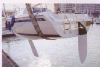
**SAILART** Schwenkkiel, flacher Spant, abgeknicktes Heck. Auch der Aufbau ist kantig
